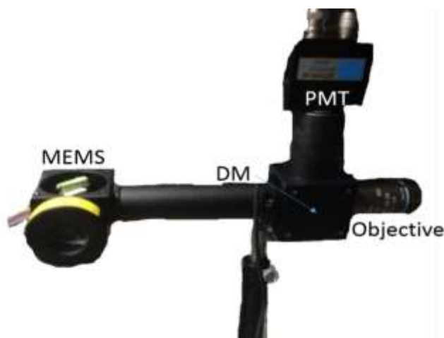
図 2.3 SHG 測定プローブ (写真)
